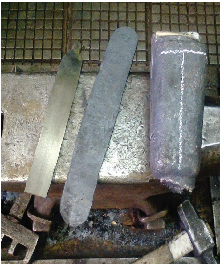
Рис. 5. Ковка белого чугуна БЧ27А в полосу 6 мм и 3 мм
